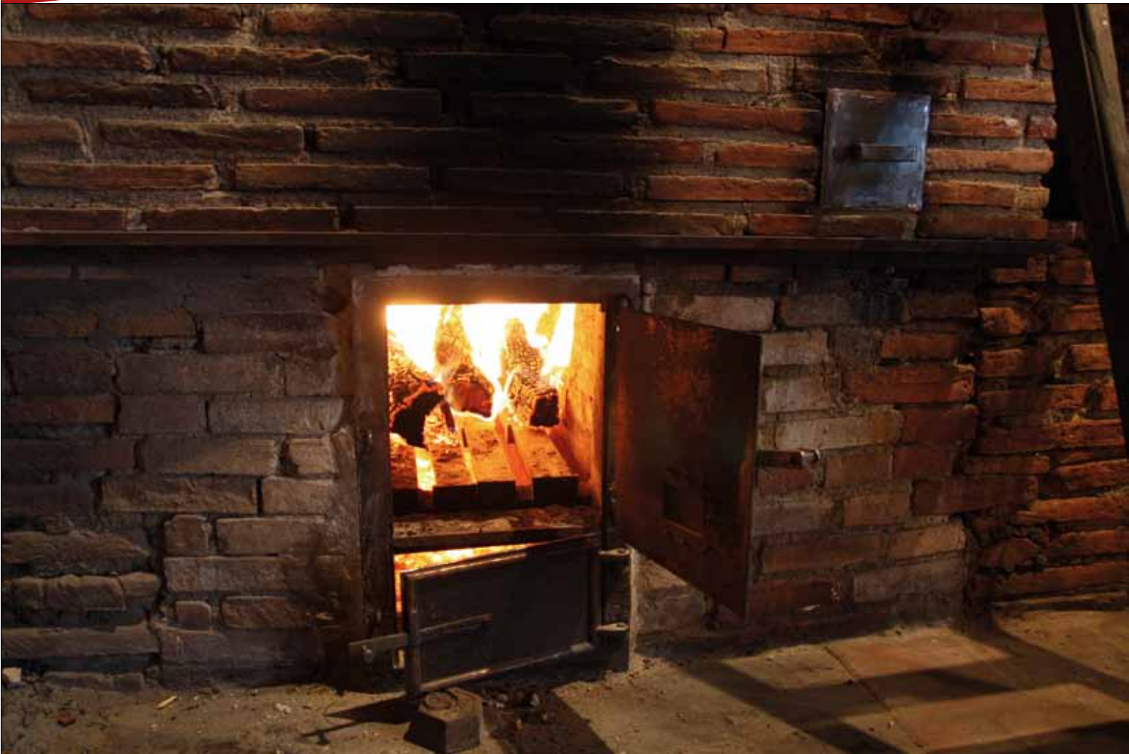
Le foyer de l'alambic de 1804, alimenté par des bûches, est en contact direct avec la première chaudière.
